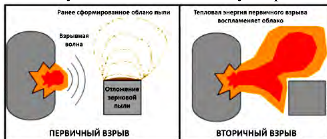
Рисунок 3 - Возникновение вторичного взрыва при аварийной ситуации на силосе/бункере
