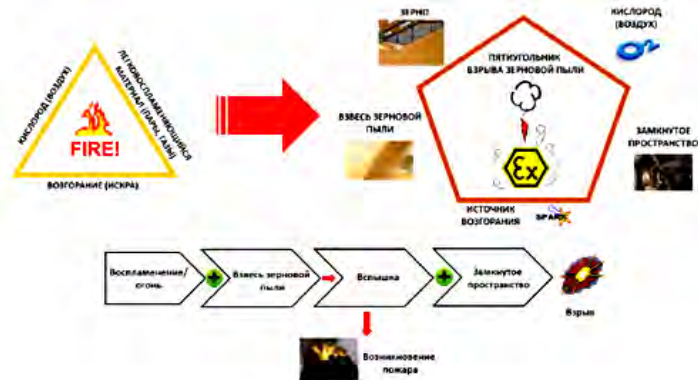
Рисунок 2 - Возникновение и ход аварийной ситуации на объектах хранения, переработки и использования зернового сырья
