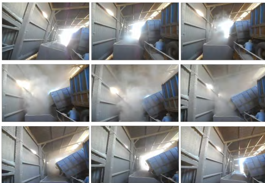
Рисунок 1 – Образование пылевого облака при выгрузке пшеницы
